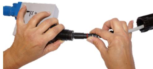
4.3 Inserisce l'estremità del cavo galleggiante del trasformatore nella presa nera "POWER". Attenzione al senso della presa.
